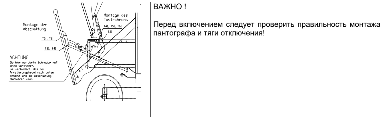
Монтаж штанги отключения
